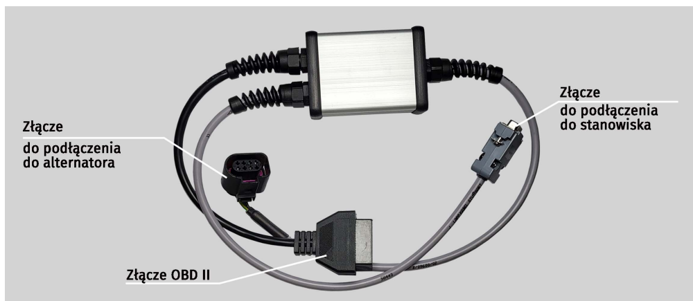
Rysunek 8. Kabel do badania pasowych alternatorów-rozruszników 48 V
