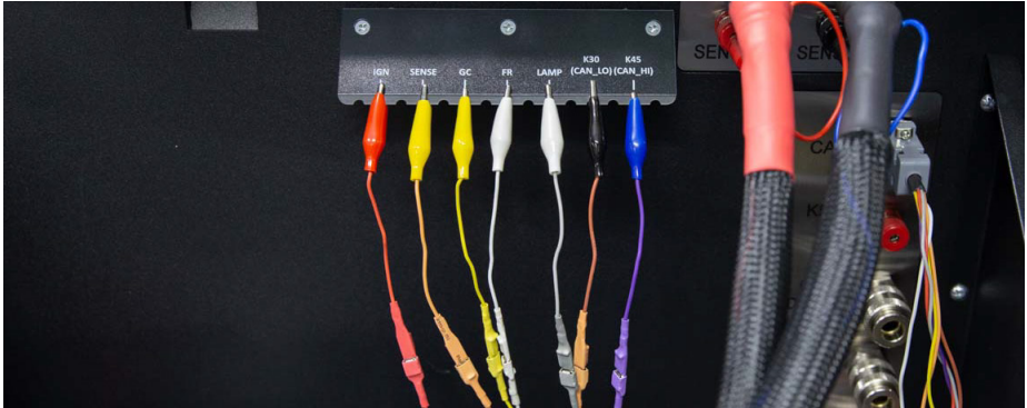
Figura 7. Abrazaderas de cable de diagnóstico universal fijadas en el soporte
