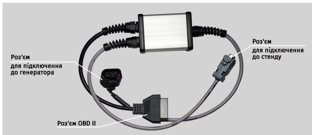
Рисунок 8. Кабель для перевірки ремінних стартер-генераторів 48 В
