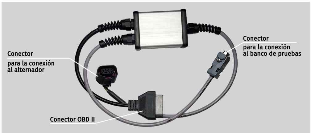
Figura 8. Cable de prueba de los alternadores de arranque de correa de 48 V
