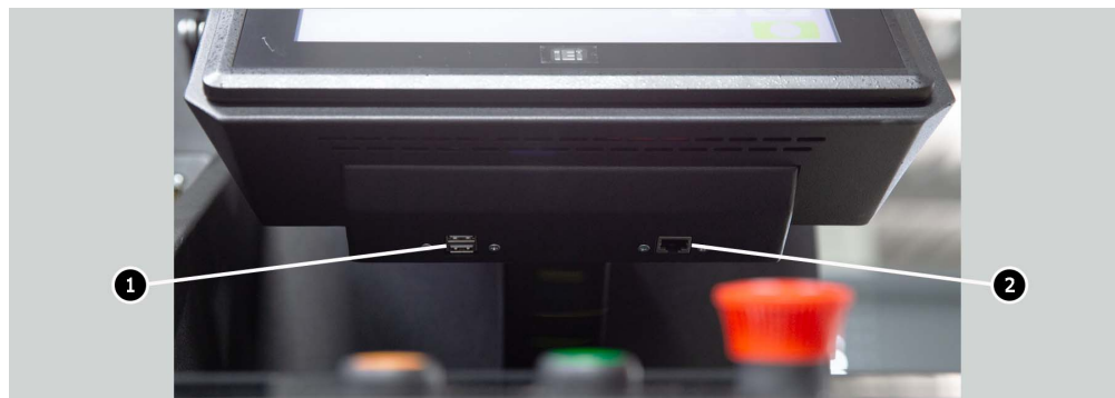
Rysunek 4. Lokalizacja złączy USB i LAN
